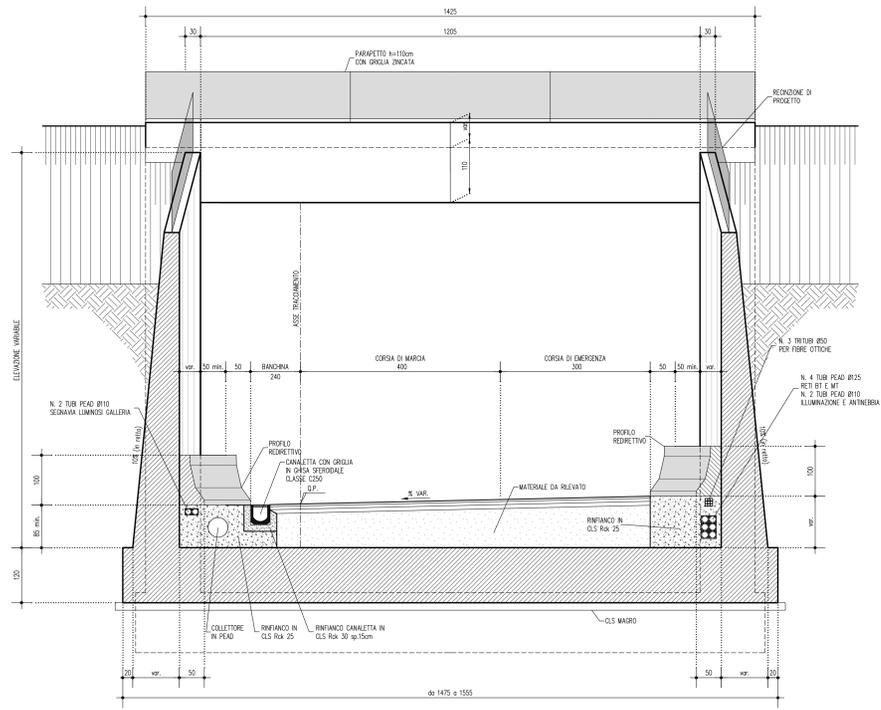
SEZIONE TRASVERSALE SUL MURO AD "U" IN TRINCEA 1:50
