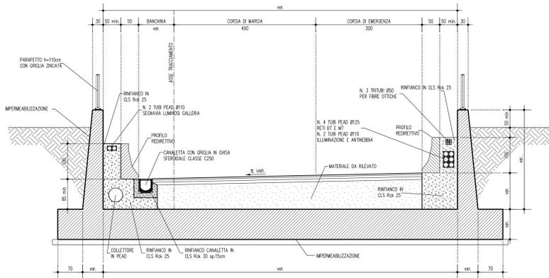
SEZIONE TRASVERSALE SUL MURO AD "U" IN TRINCEA 1:50
