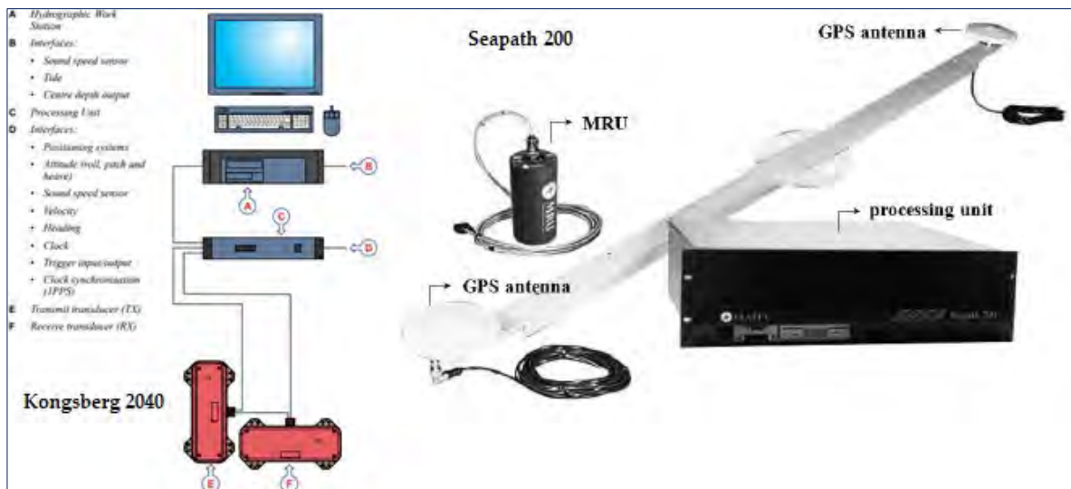
Figura 3.1: Sistema Multibeam Kongsberg 2040 con sistema di navigazione e posizionamento Seapath 200
