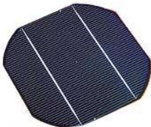
Figura 2.1: Cella fotovoltaica in silicio monocristallino.
