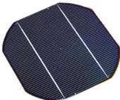
Figura 2.1: Cella fotovoltaica in silicio monocristallino.
