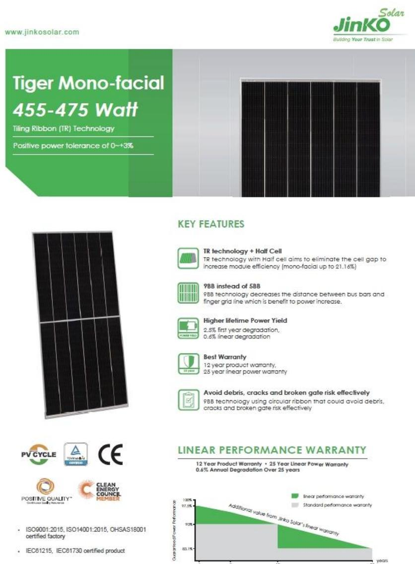
Figura 3.5: Caratteristiche Dimensionali ed Elettriche del Modulo
