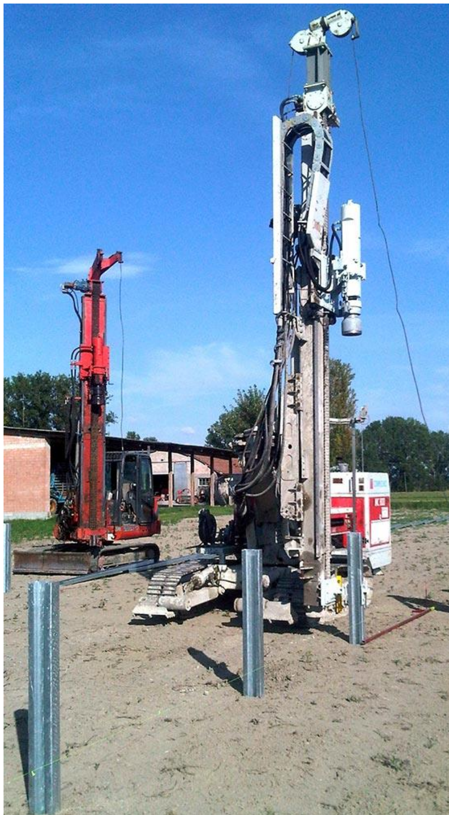
Figura 2.2: Esempio di Macchina Operatrice Battipalo
