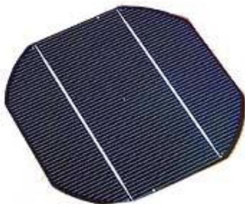
Figura 2.1: Cella fotovoltaica in silicio monocristallino.
