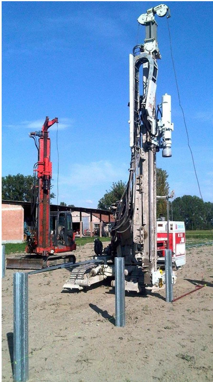
Figura 2.2: Esempio di Macchina Operatrice Battipalo
