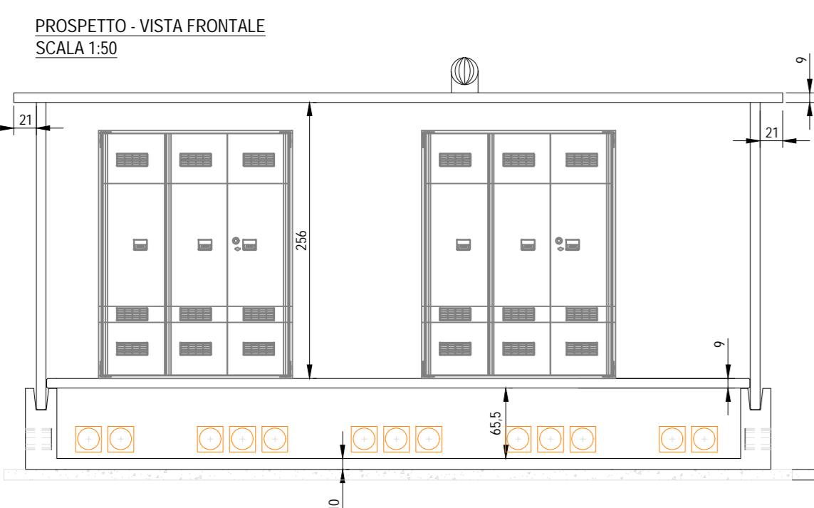
TIPICO POWER STATION - CABINE DI TRASFORMAZIONE
