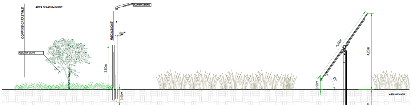
Figura 4-13: Sezione tipo della fascia perimetrale di mitigazione
