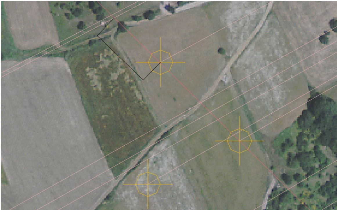
Figura 12: esempio di misurazione della distanza tra le congiungenti sul piano di proiezione
