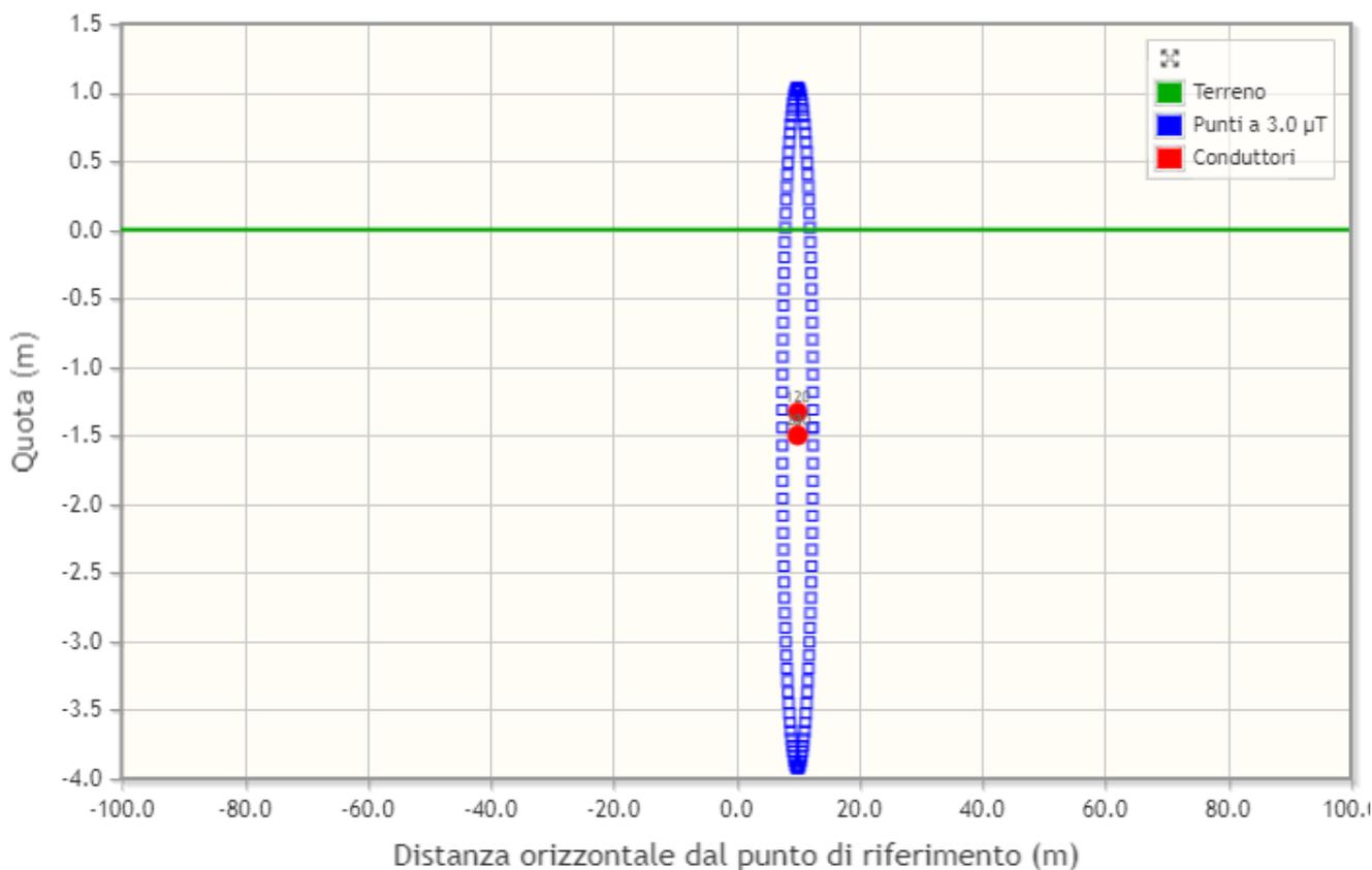
Si può quindi considerare che l'ampiezza della fascia di rispetto con valore del campo magnetico indotto inferiore a  $3\mu\text{T}$  sia pari a 2,5m, a cavallo dell'asse del cavidotto.
