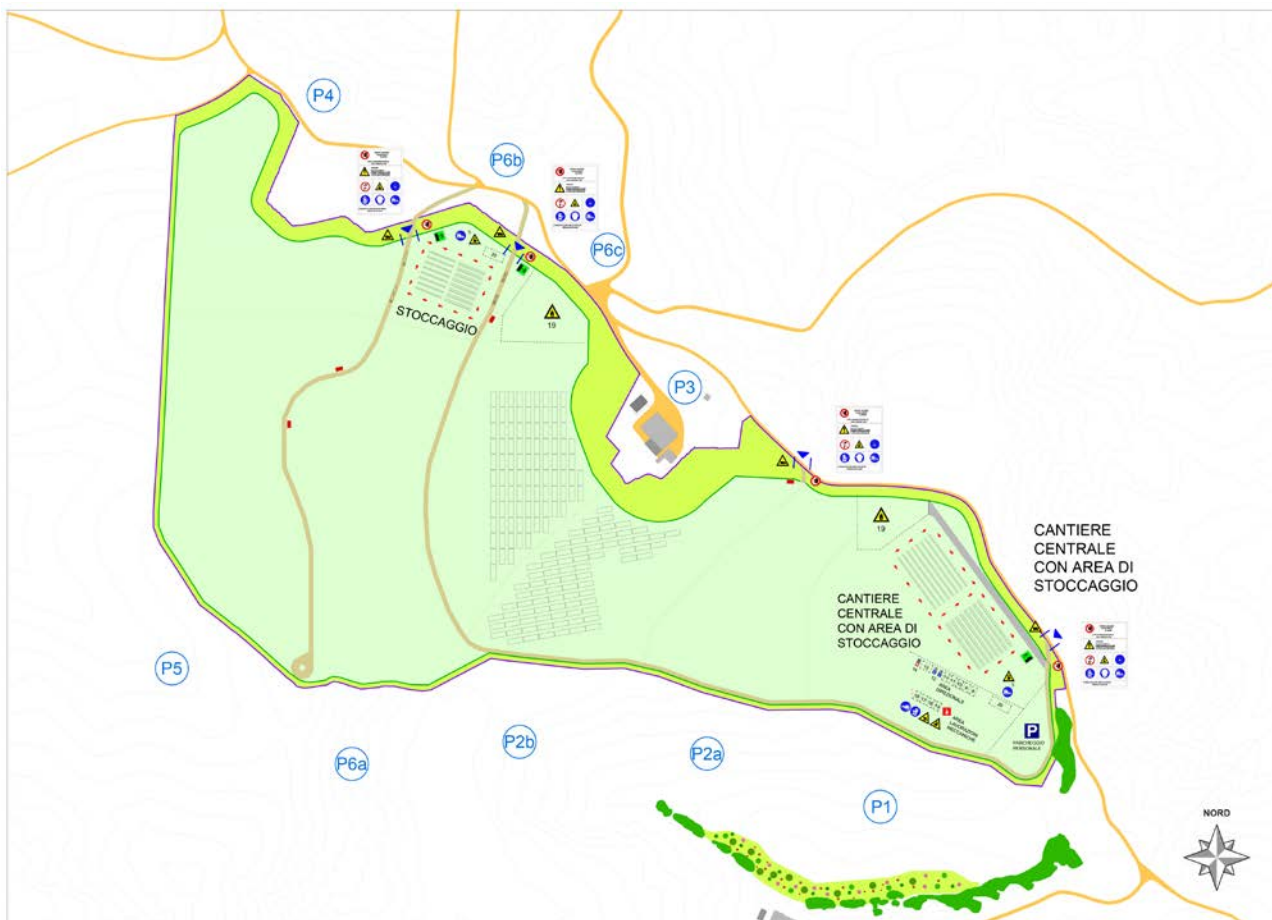
Fig. 3 – Sviluppo del cantiere durante le fasi installative di strutture e moduli
