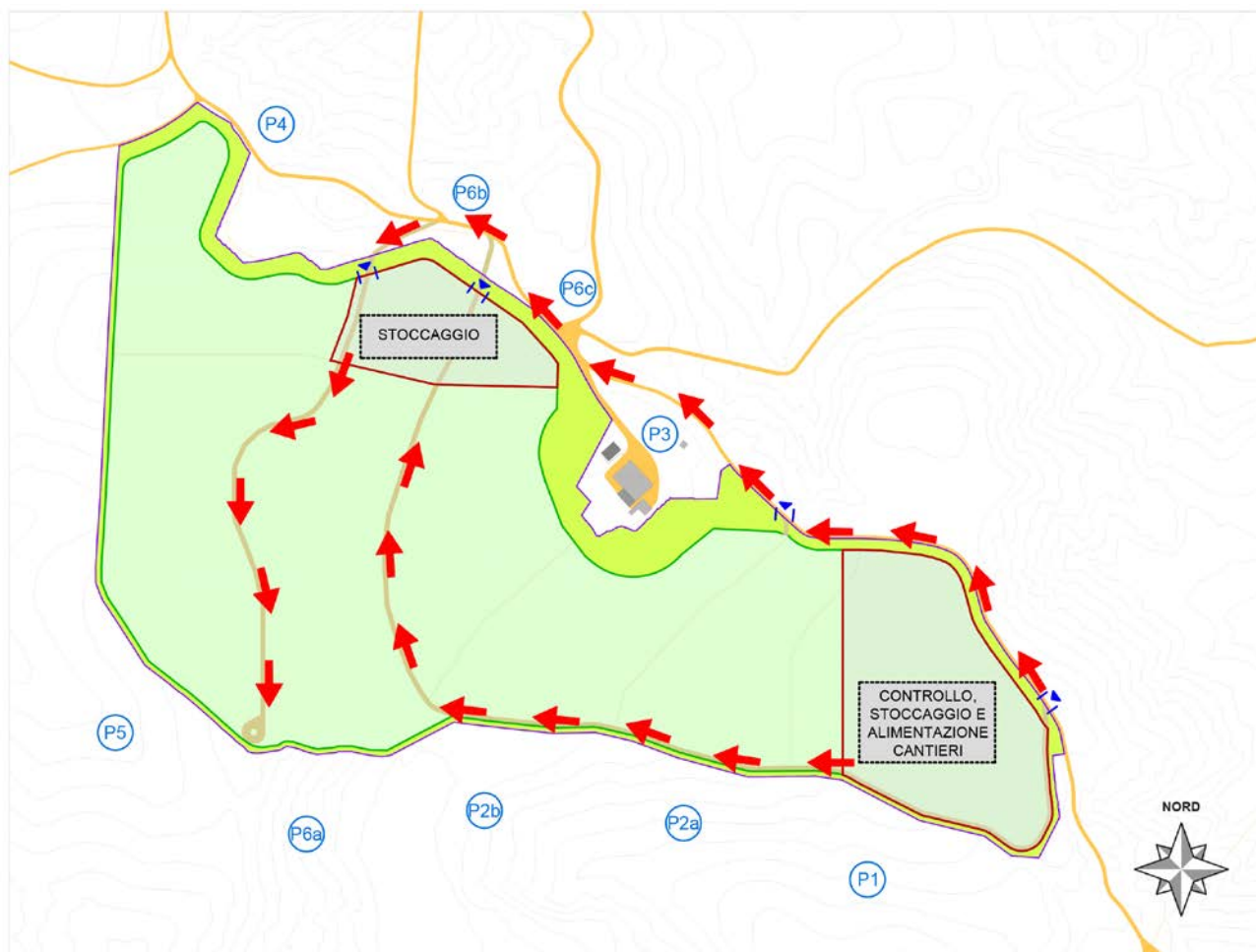
Fig.1 – Schema generale di cantiere
