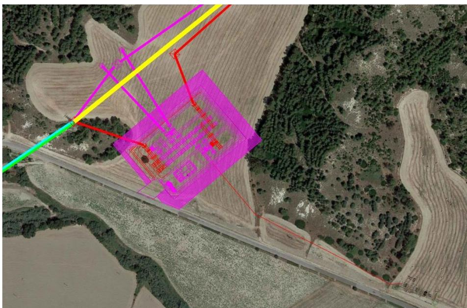
*Figura 44 - Nuova SE e ubicazione della stazione di elevazione AT/MT*
