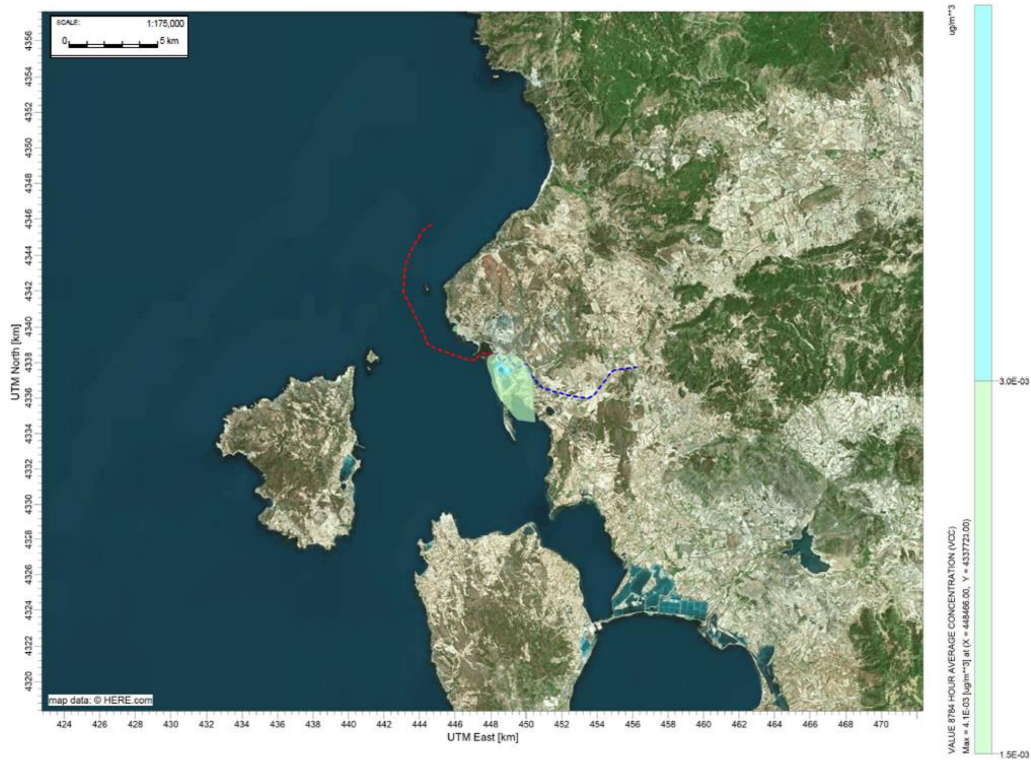
Figura 4-18: Andamenti delle concentrazioni medie annue di NMCOV (valutato come Benzene) (Limite annuo D. Lgs 155/10: 5 µg/m³) (in rosso il tragitto delle metaniere, in blu quello dei mezzi terrestri)
