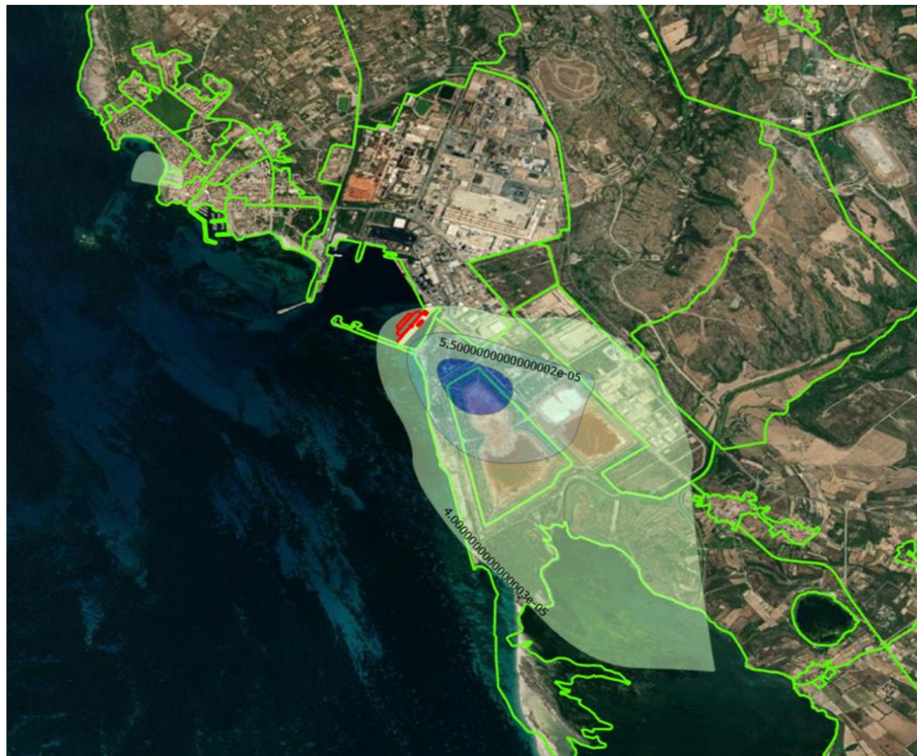
Figura 4-21: Andamenti delle concentrazioni medie annue di Benzo(a)Pirene (Valore Obiettivo D. Lgs 155/10: 1 ng/m 3 ) – Dettaglio con Sezioni Censuarie
