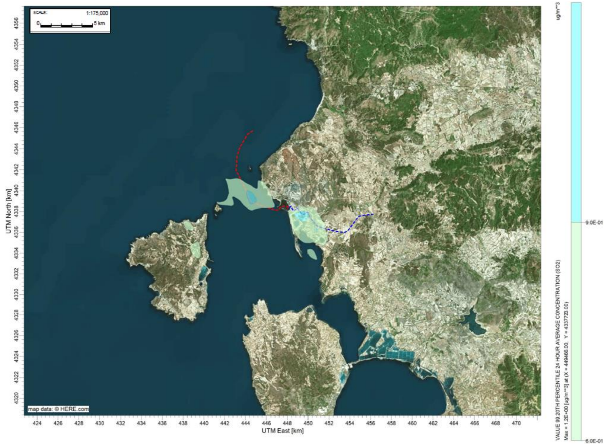
Figura 4-10: Andamenti al 99,2 percentile delle concentrazioni medie giornaliere di SO 2 (Limite giornaliero D. Lgs 155/10: 125 µg/m 3 da non superare più di 3 volte in un anno) (in rosso il tragitto delle metaniere, in blu quello dei mezzi terrestri)
