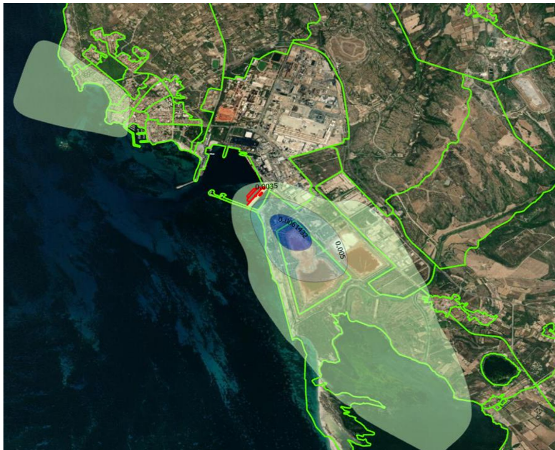
Figura 4-17: Andamenti delle concentrazioni medie annuali di PM 10 (Limite annuo D. Lgs 155/10: 40 µg/m 3 ) – Dettaglio con Sezioni Censuarie
