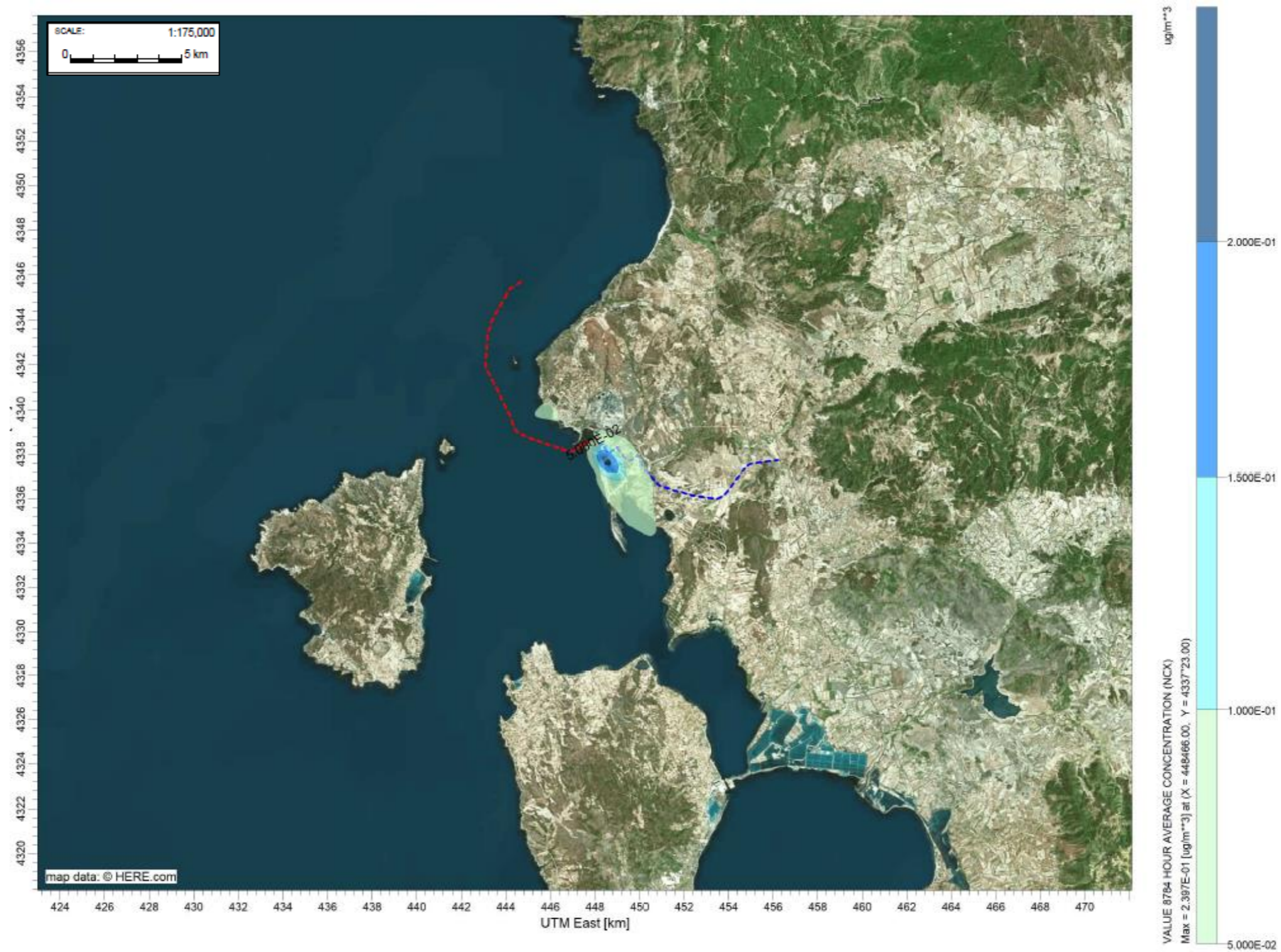
Figura 4-6: Andamenti delle concentrazioni medie annuali di NO 2 (Limite annuo D. Lgs 155/10: 40 µg/m 3 ) (in rosso il tragitto delle metaniere, in blu quello dei mezzi terrestri)
