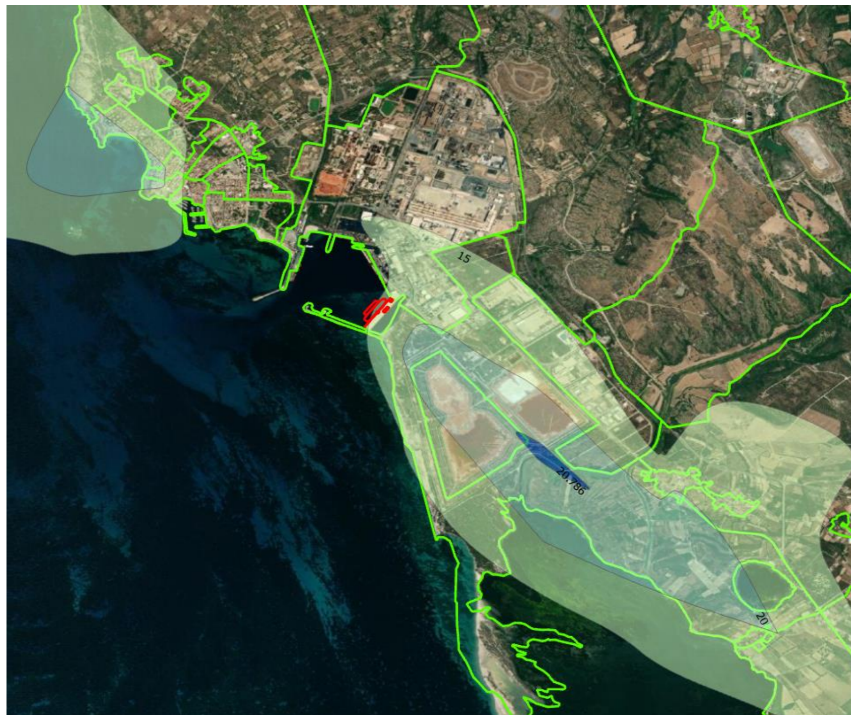
Figura 4-5: Andamenti al 99,8 percentile delle concentrazioni orarie di NO 2 (Limite orario D. Lgs 155/10: 200 µg/m 3 da non superare più di 18 volte in un anno) - Dettaglio con Sezioni Censuarie
