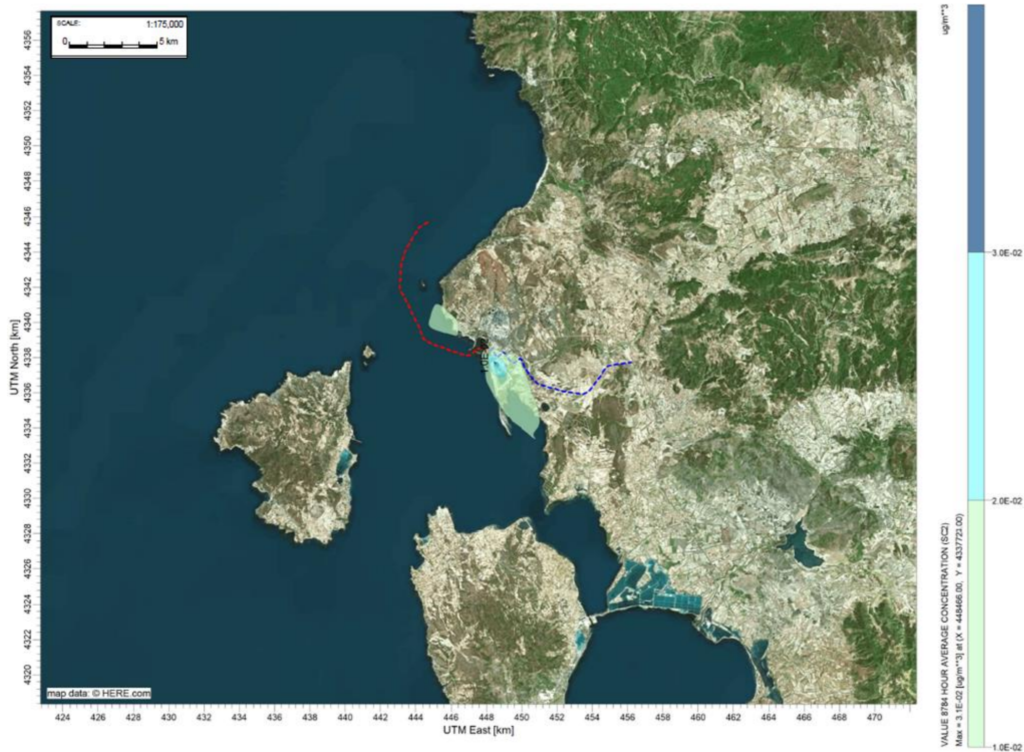
Figura 4-12: Andamenti delle concentrazioni medie annuali di SO 2 (Limite annuo D. Lgs 155/10: 20 µg/m 3 ) (in rosso il tragitto delle metaniere, in blu quello dei mezzi terrestri)
