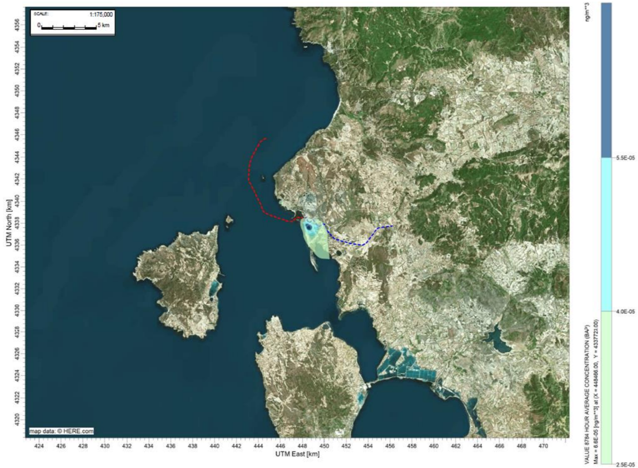
Figura 4-20: Andamenti delle concentrazioni medie annue di Benzo(a)Pirene (Valore Obiettivo D. Lgs 155/10: 1 ng/m 3 ) (in rosso il tragitto delle metaniere, in blu quello dei mezzi terrestri)
