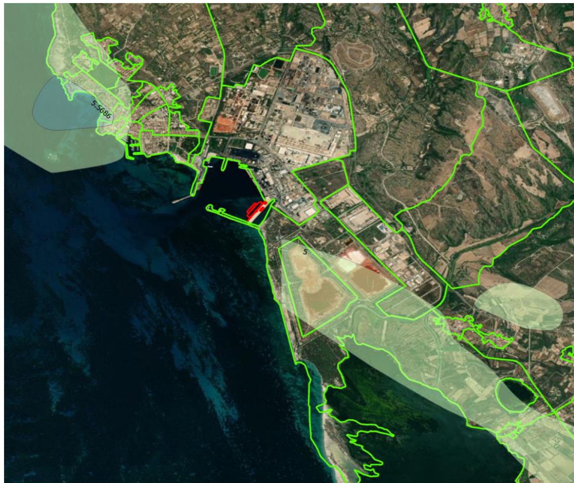
Figura 4-9: Andamenti al 99,7 percentile delle concentrazioni orarie di SO 2 (Limite orario D. Lgs 155/10: 350 µg/m 3 da non superare più di 24 volte in un anno) – Dettaglio con Sezioni Censuarie
