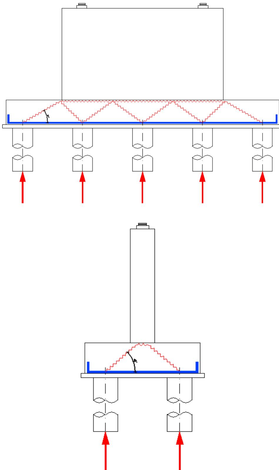
Le armature trasversali sono progettate con il primo schema mentre quelle longitudinali con il secondo.
