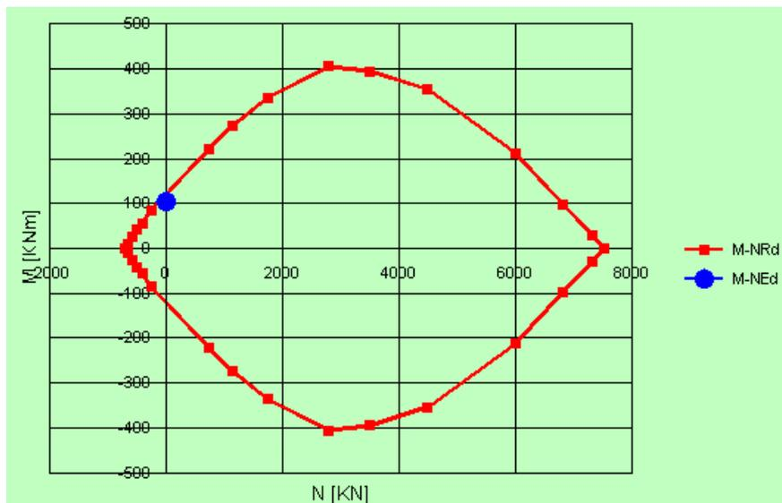
FIGURA 27 DOMINIO RESISTENTE SEZIONE LONGITUDINALE CAMAPATA SOLETTA
