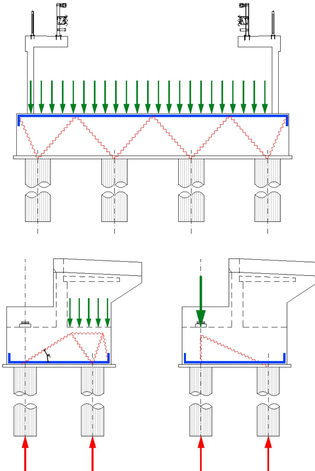
Le armature trasversali sono progettate con i primi due schemi mentre quelle longitudinali secondo i secondi due.
