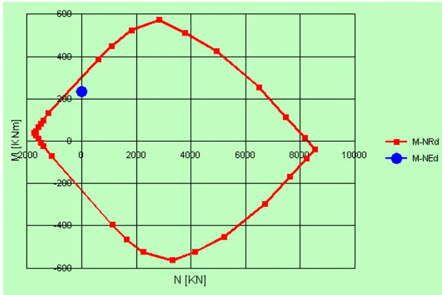
FIGURA 26 DOMINIO RESISTENTE SEZIONE TRASVERSALE CAMAPATA SOLETTA
