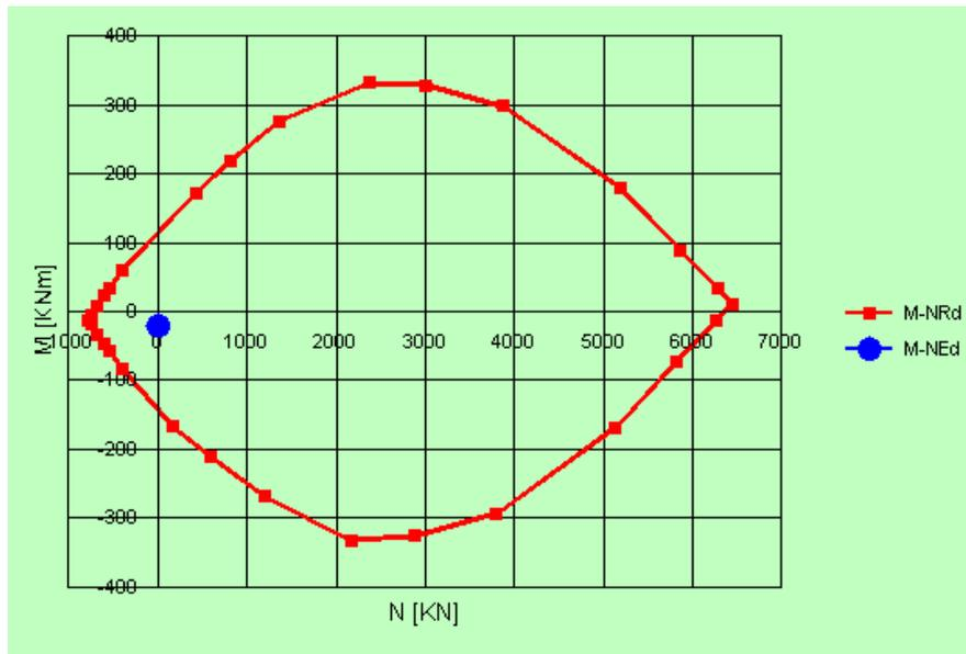
FIGURA 25 DOMINIO RESISTENTE SEZIONE LONGITUDINALE ATTACCO DELLA SBALZO
