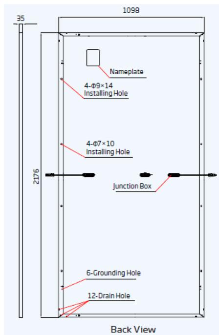
**figura 3 – caratteristiche dimensionali dei moduli**
