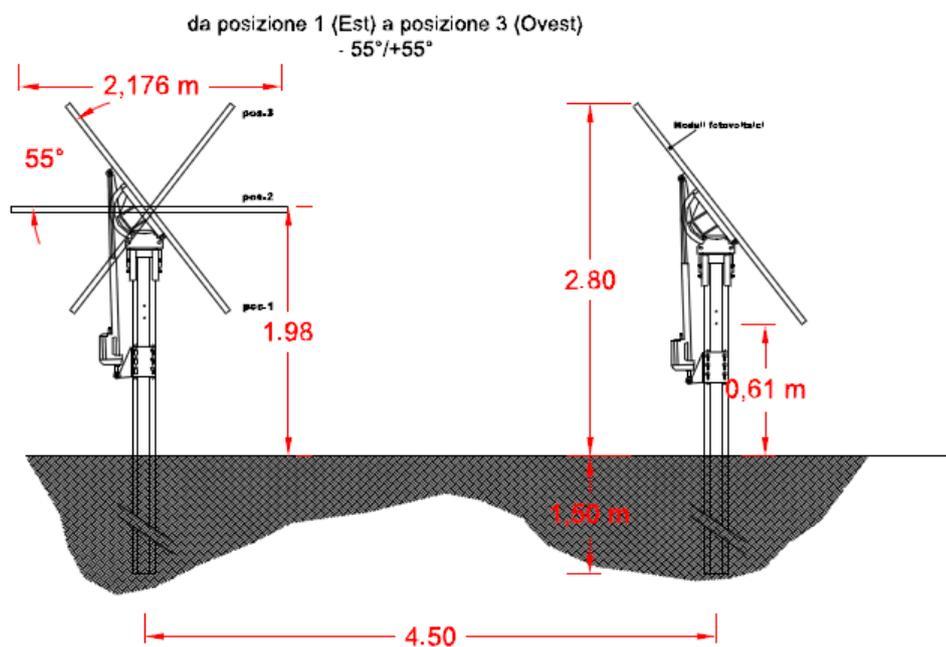
**Fig. 4 - Dimensioni principali del tracker**
