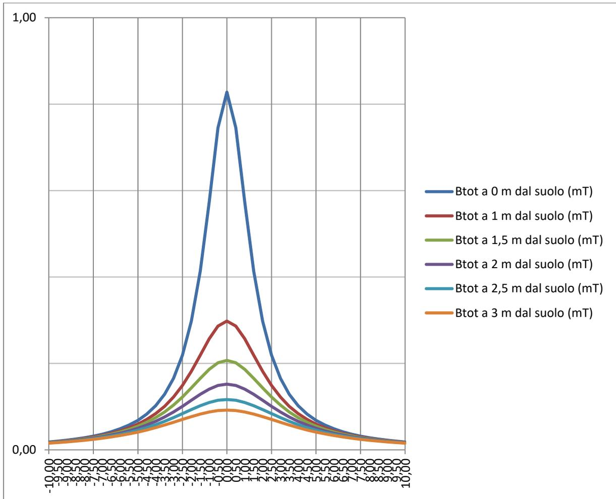
Il grafico mostra come nel caso in esame (cavidotto AT interrato ad una profondità di 1,5 m), il valore del Campo di Induzione Elettromagnetica sia al di sotto dell'obiettivo di qualità, pari a  $3 \mu\text{T}$ .
