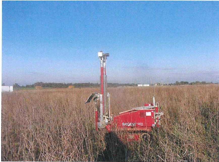
**Esecuzione prova penetrometrica**
