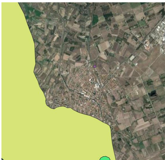
Figura 28 Fasce PSFF – in giallo: Hi1; in viola: Hi2; in blu: Hi3; in verde: Hi4. Sito di intervento: pallino magenta.
