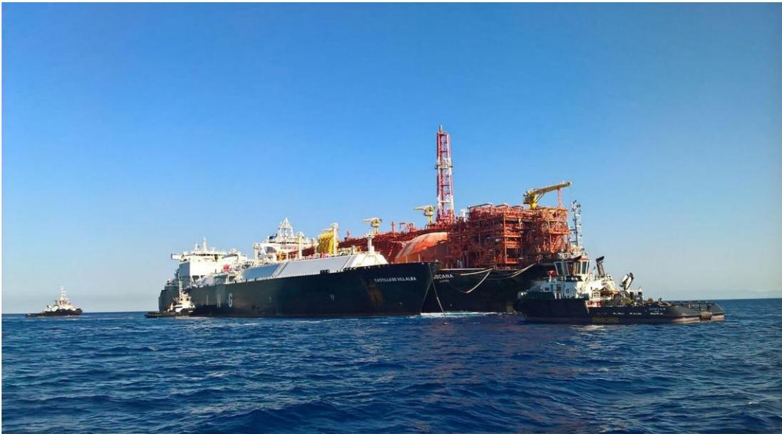
Figura 2.3: Ormeggio di una Nave Metaniera al Terminale
