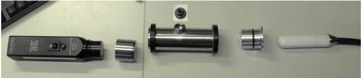
Figura C-1. Vista divisa di un calibratore a pistone GRAS 42AC con un idrofono M15B.
