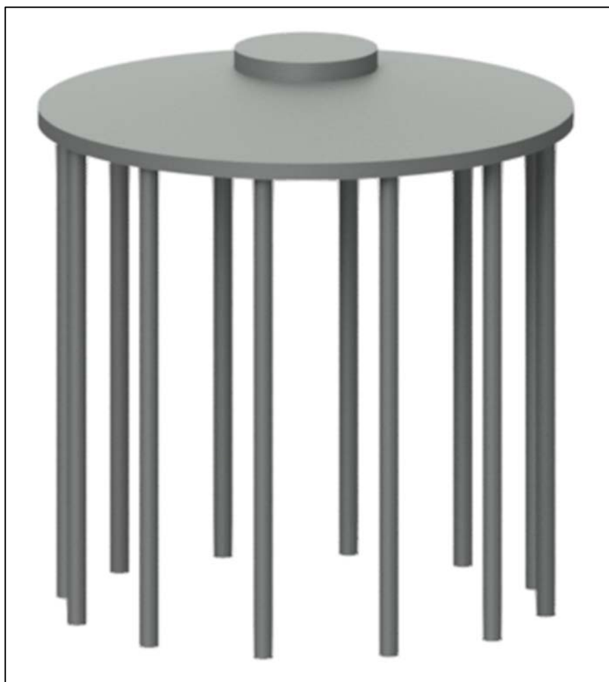
Figura 1: vista tridimensionale della fondazione dell'aerogeneratore
