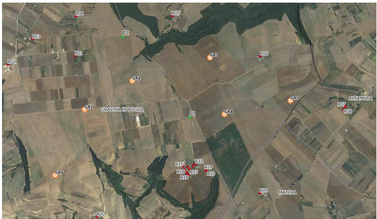
Figura 2. Area di indagine componente rumore – Postazioni di misura (Pi), aerogeneratori di progetto (GRi) e ricettori (Ri)
