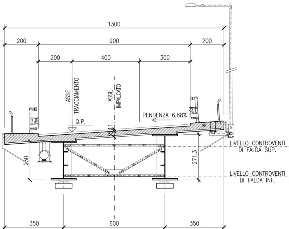
FIGURA 3-3: SEZIONE TRASVERSALE TIPO.
