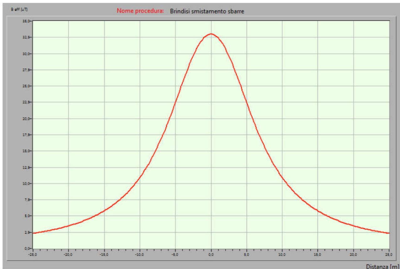
**Profilo laterale induzione magnetica (B) sbarre 150 kV**
