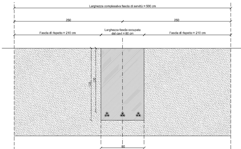
**Figura 4 - Sezione tipo scavo e fasce di rispetto per vincolo di servitù**
