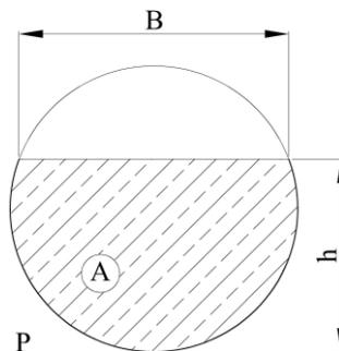
Nel caso di moto assolutamente turbolento il coefficiente di conduttanza non è più dipendente dal numero di Reynolds e può essere espresso da formule empiriche che mettono in relazione tale coefficiente con il coefficiente di scabrezza ed il raggio idraulico.
