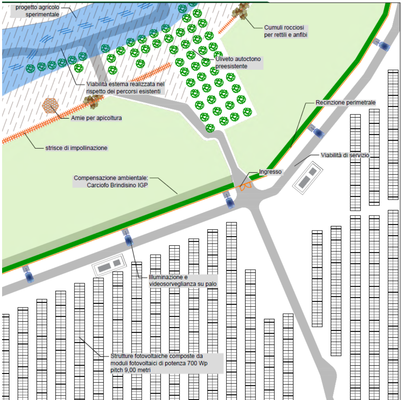
Figura 9-9: particolare costruttivo degli elementi di mitigazione naturalistica
