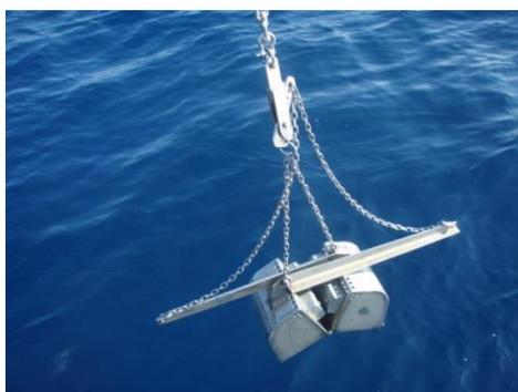
**Fig. 2.5** – Benna Van Veen utilizzata per il prelievo di campioni di sedimento da destinare alle indagini ecotossicologiche.
