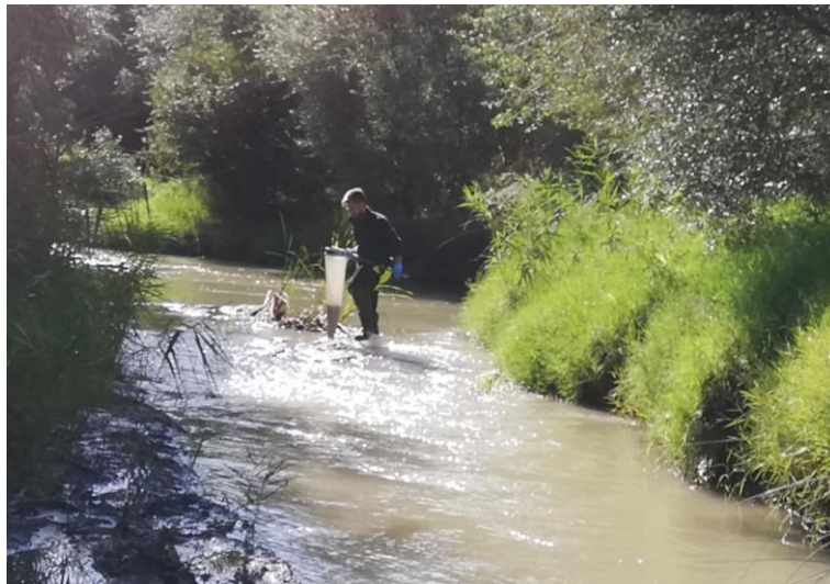
Fig. 4: ASU 02 - Fiume Fortore: Campionamento con retino immanicato modificato surber
