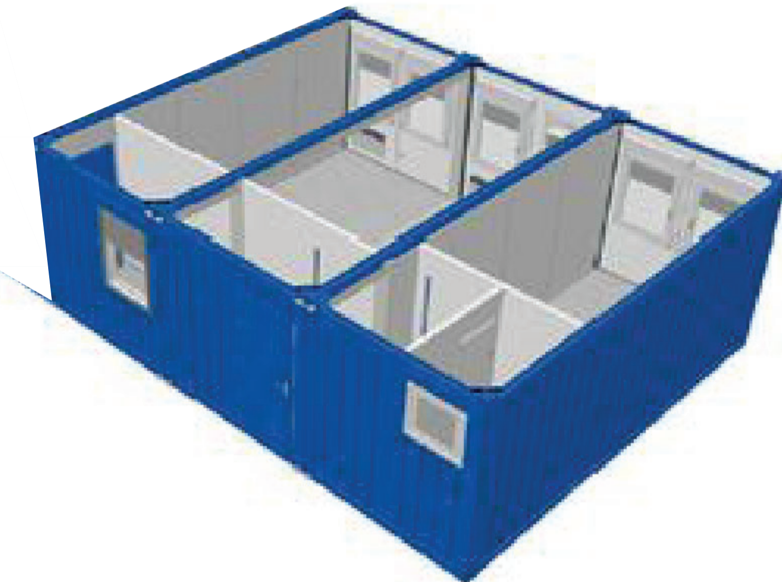
Prefabbricato modulare ad uso INFERMERIA impianto da 3 unità (Tipologia utilizzata anche per locale MENZA e locale SALA RIUNIONE)
