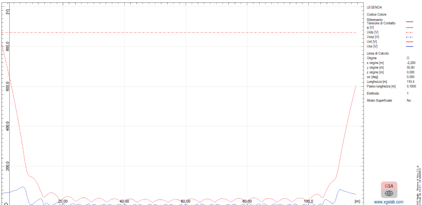
Figura 29 – ALLEGATO 2 – C.to circuitatore NON intervenuto - Distribuzione lineare del potenziale di terra UE, della tensione di contatto U_t e di passo U_s “Linea di calcolo 1”
