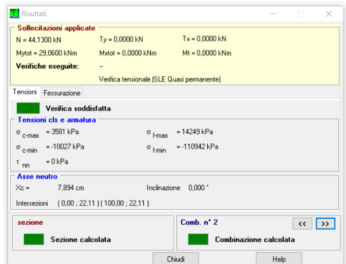
Figura 9-15 – Risultati verifica tensionale (QP).
