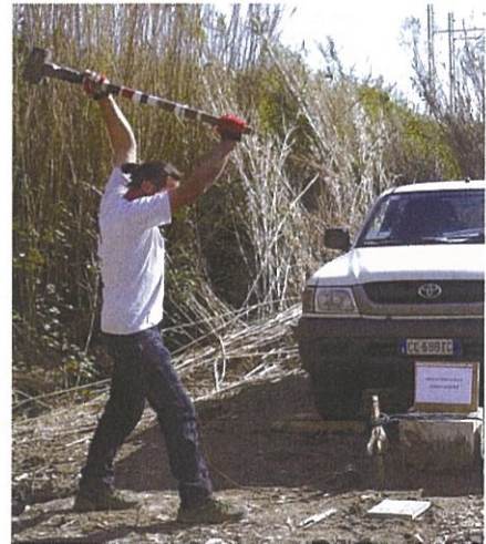
Energizzazione Onde P
