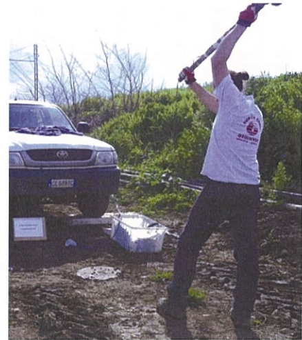
Energizzazione Onde P
