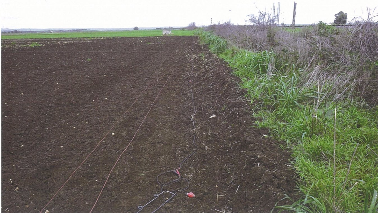
Stendimento sismico per registrazione Re.Mi. / MASW
