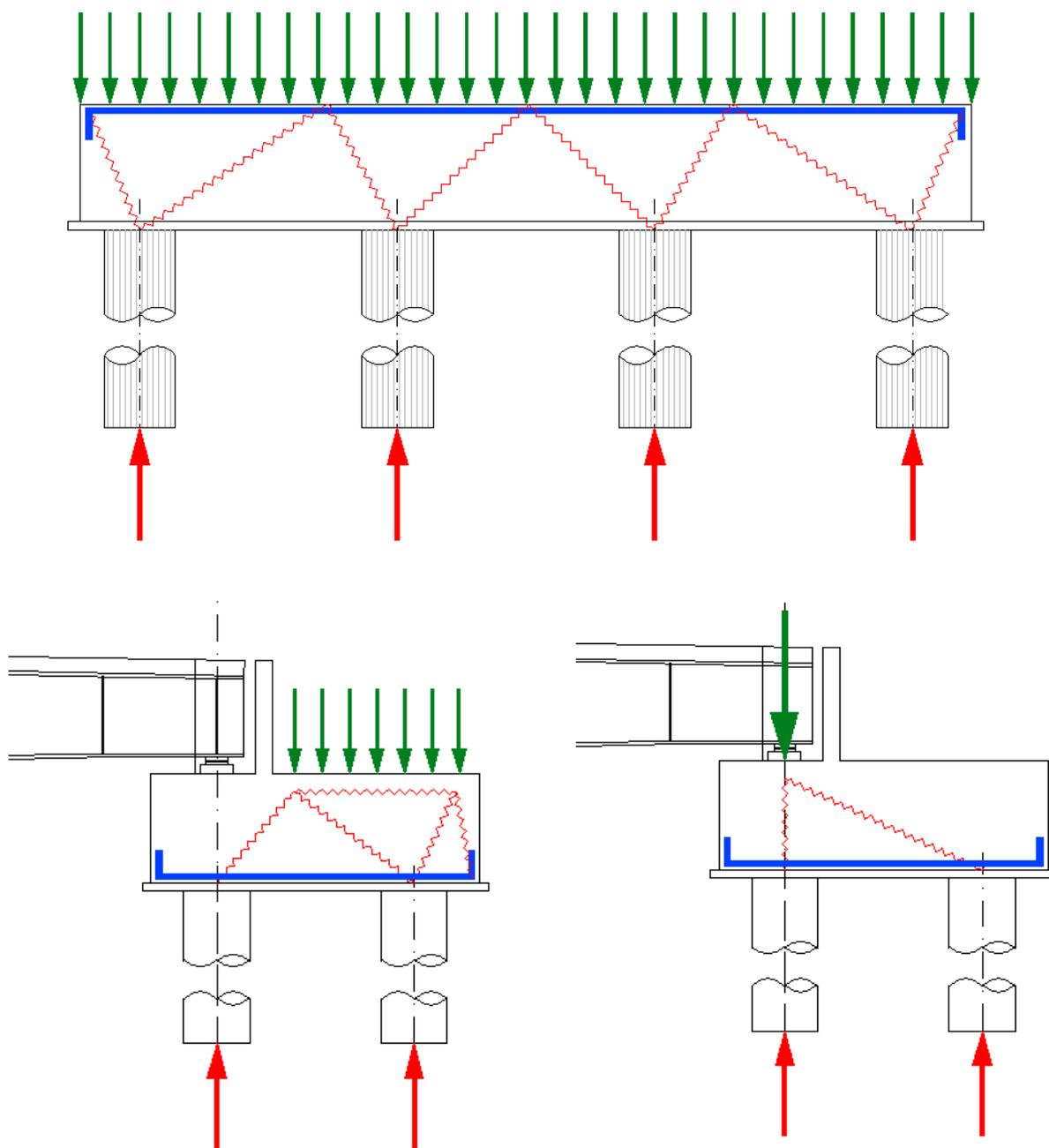
Le armature trasversali sono progettate con i primi due schemi mentre quelle longitudinali secondo i secondi due.
