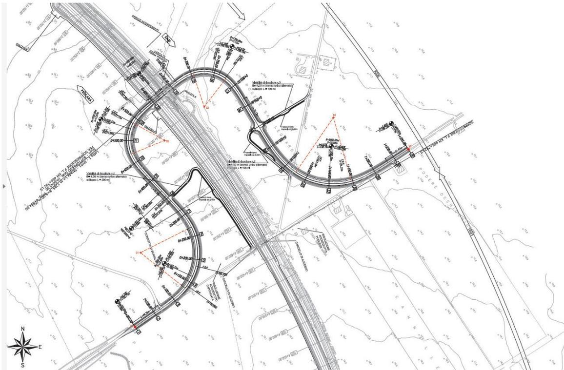
**Figura 28 – Stralcio planimetrico nuova viabilità per soppressione PL**
