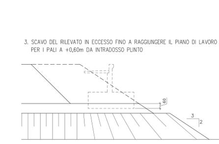
3. SCAVO DEL RILEVATO IN ECCESSO FINO A RAGGIUNGERE IL PIANO DI LAVORO PER I PALI A +0,60m DA INTRADOSSO PIUNTO
