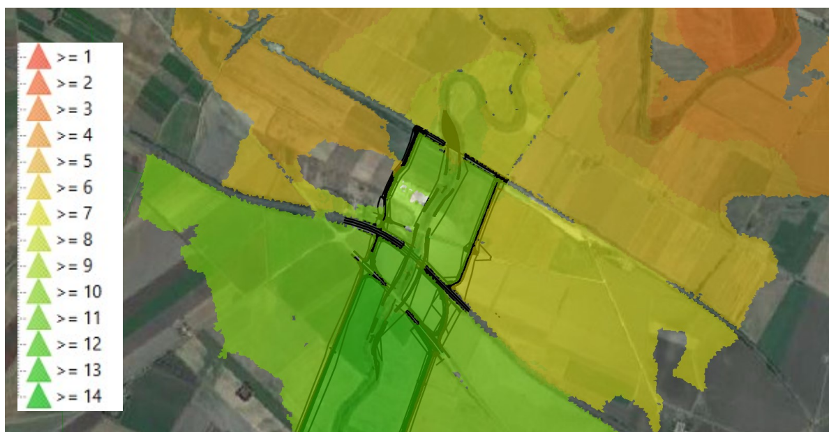
Figura 6-2 – Dettaglio delle tracimazioni sulle infrastrutture stradali e ferroviarie – Ante operam – TR200
