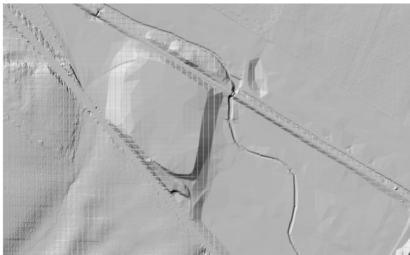
Figura 5 – DTM di riferimento ricostruito sulla base del rilievo celerimetrico
