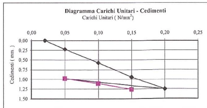
per incrementi di carico tra 0,05 e 0,15 N/mm<sup>2</sup> incremento del cedimento  $\Delta s = 0,72$  mm  $M_d = 41,67$  N/mm<sup>2</sup>
