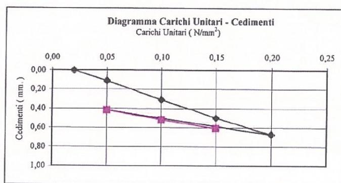
per incrementi di carico tra 0,05 e 0,15 N/mm<sup>2</sup> incremento del cedimento  $\Delta s = 0,39$  mm  $M_d = 76,92$  N/mm<sup>2</sup>
