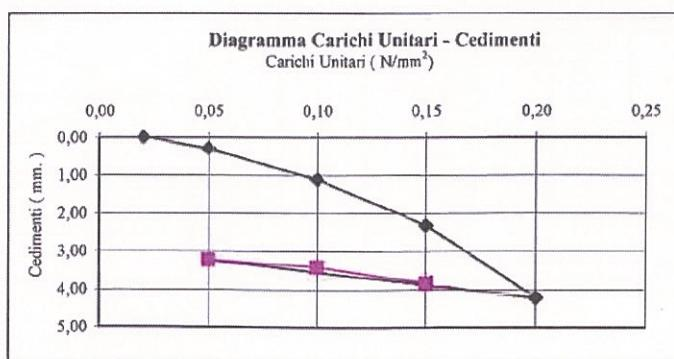
per incrementi di carico tra 0,05 e 0,15 N/mm<sup>2</sup> incremento del cedimento  $\Delta s = 2,01$  mm  $M_d = 14,93$  N/mm<sup>2</sup>
