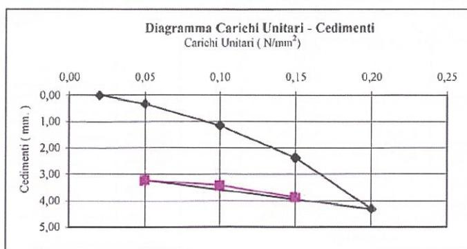
per incrementi di carico tra 0,05 e 0,15 N/mm<sup>2</sup> incremento del cedimento  $\Delta s = 2,04$  mm  $M_d = 14,71$  N/mm<sup>2</sup>
