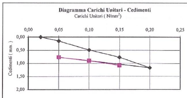
per incrementi di carico tra 0,05 e 0,15 N/mm<sup>2</sup> incremento del cedimento  $\Delta s = 0,62$  mm  $M_d = 48,39$  N/mm<sup>2</sup>
