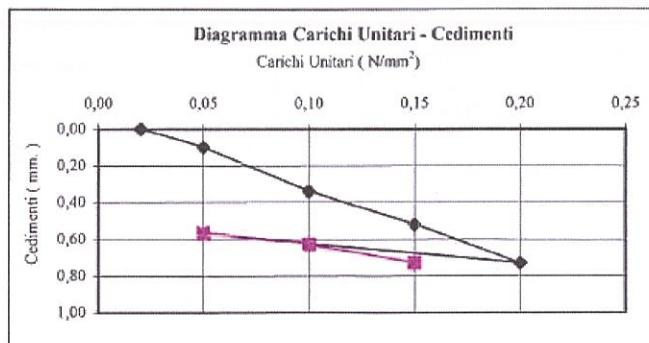
per incrementi di carico tra 0,05 e 0,15 N/mm<sup>2</sup> incremento del cedimento  $\Delta s = 0,42$  mm  $M_d = 71,43$  N/mm<sup>2</sup>
