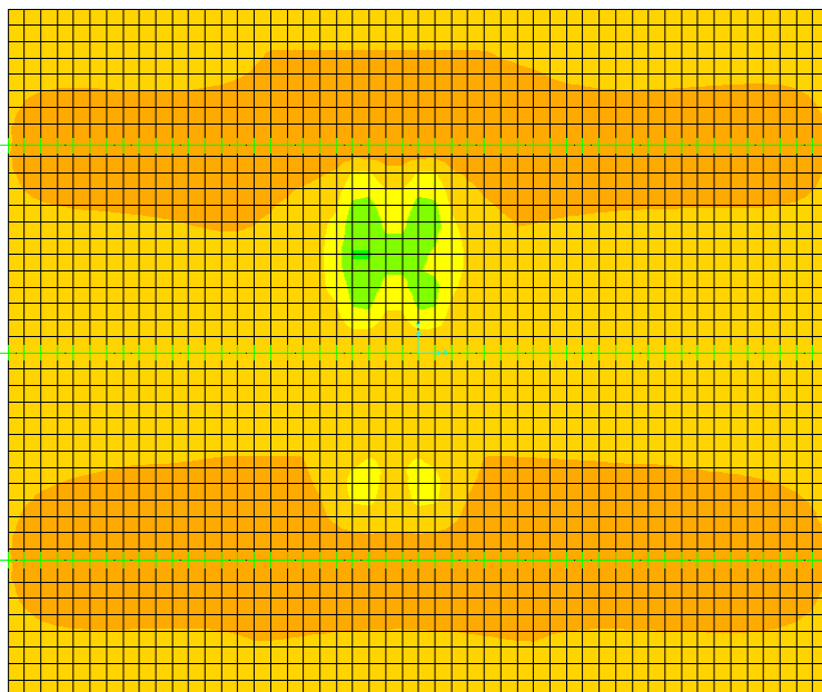
FIGURA 18 MOMENTO FLETTENTE - SOLLECITA LE FIBRE PARALLELE ALLE TRAVI PRINCIPALI
