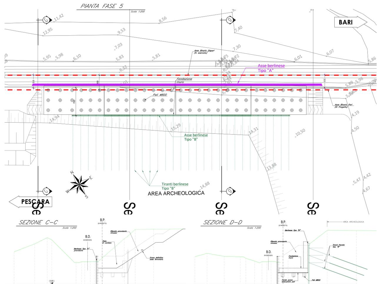
N.B. per l'esecuzione del nuovo rilevato provvisorio si prevede la formazione di una gradonatura di ammassamento, eseguita secondo le seguenti fasi costruttive:
