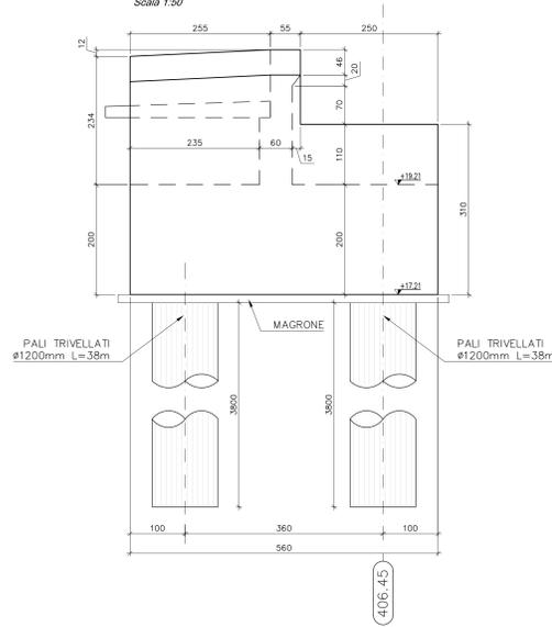
**SPALLA S1 SEZIONE A-A**
