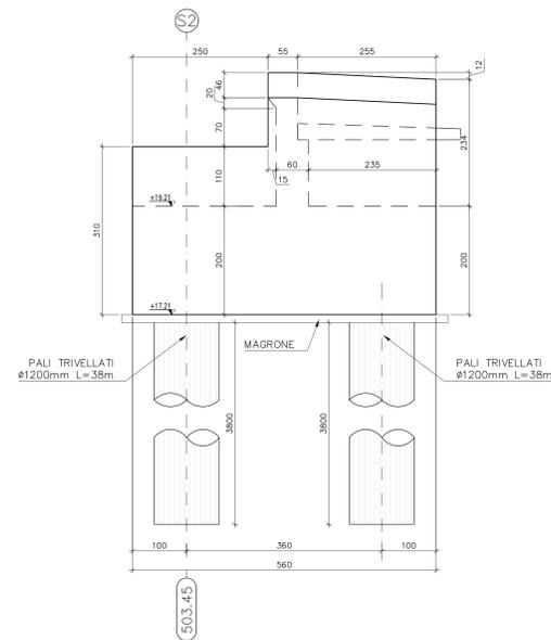
**SPALLA S2 SEZIONE A-A**
