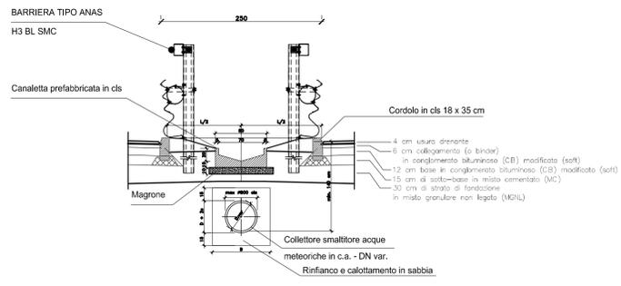
DETTAGLIO MARGINE IN RILEVATO
