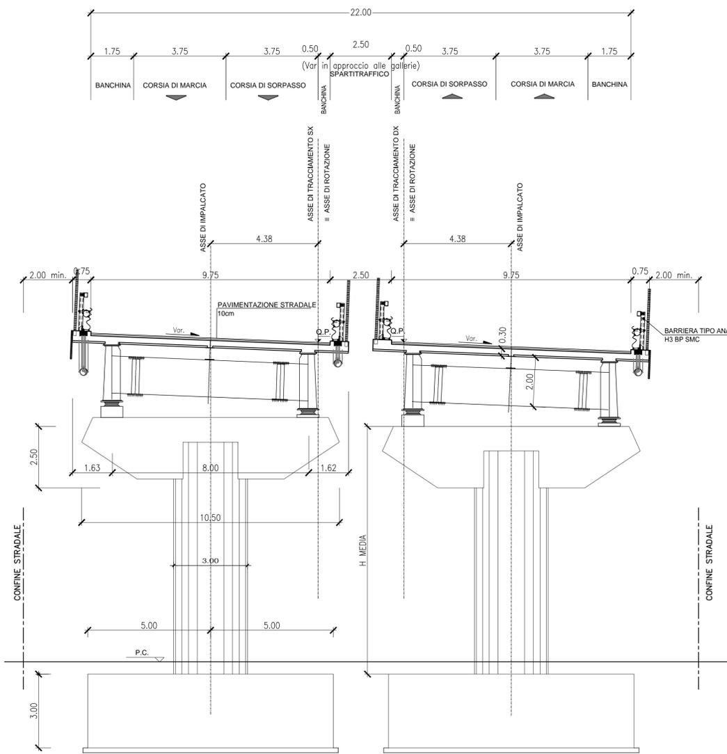
DETTAGLIO MARGINE CON MURO DI CONTRORIPA
