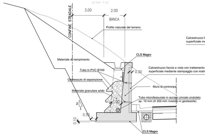
DETTAGLIO MARGINE CON MURO DI SOSTEGNO
