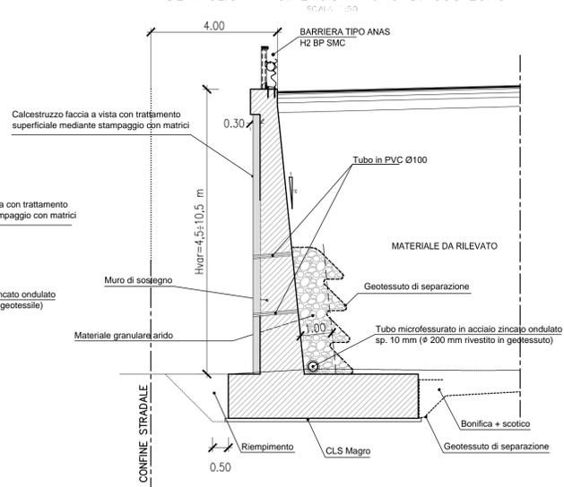
DETTAGLIO MARGINE CON MURO DI SOTTOSCARPA
