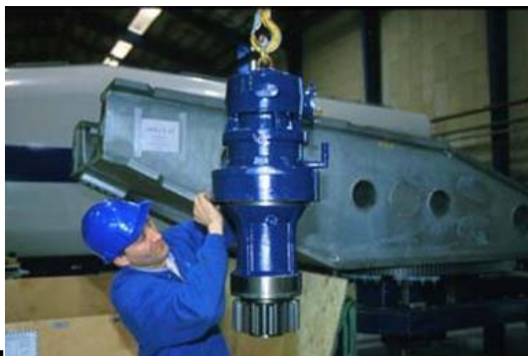
Figura 6: motori di giro e riduttori
