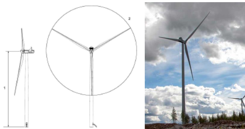
Figura 41: Caratteristiche dimensionali e compositive di un aerogeneratore tipo
