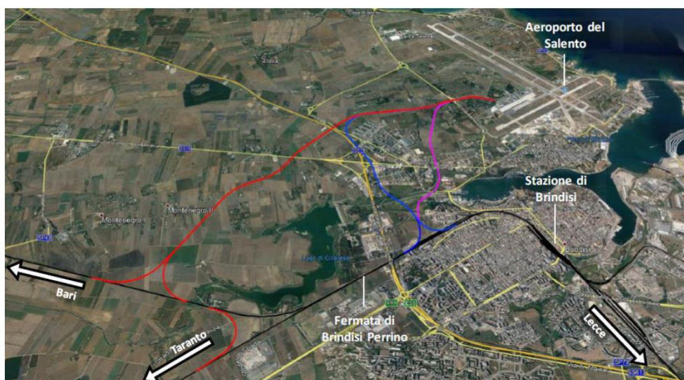
Figura 2 Alternative di progetto: Alternativa 1 (in rosso, scelta definitiva del tracciato), Alternativa 2 (in blu) ed alternativa 3 (in magenta)
