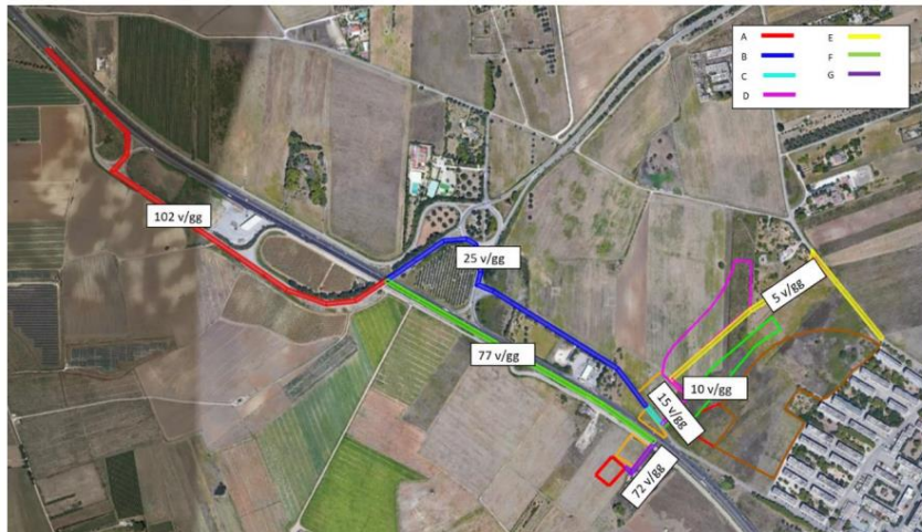
Figura 6 – Scenario 1: Viabilità di cantiere e flussi oggetto di modellazione in Aermod View (Fonte: SIA – Figura 6-26)
