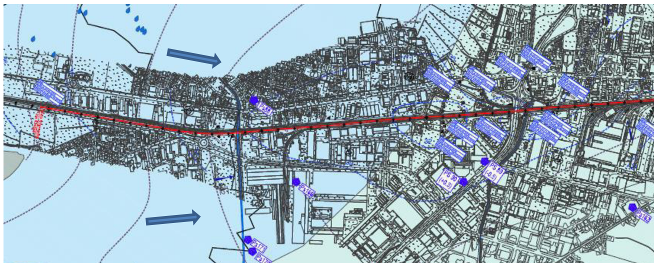
Figura -3 – Stralci della carta idrogeologica del progetto preliminare. Esempio della direzione del flusso idrico sotterraneo e isofreatiche lungo la prima porzione del tracciato
